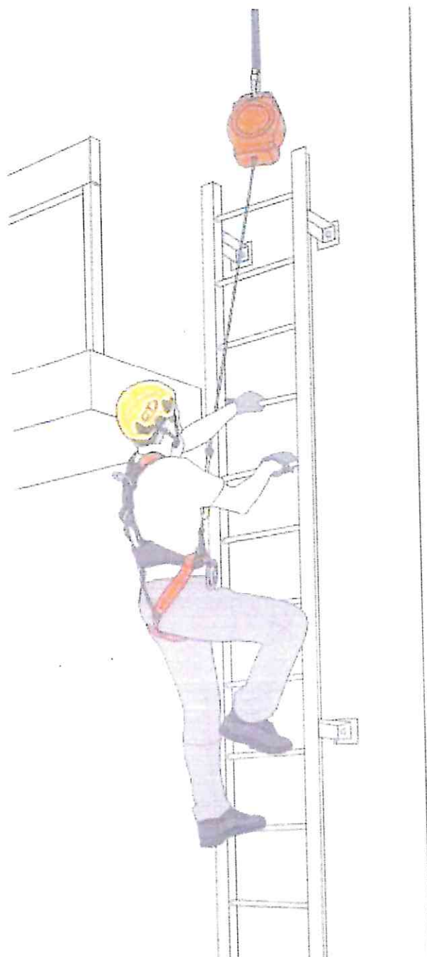
Рис. 8. Осмотр и проверка блокирующего устройства.
